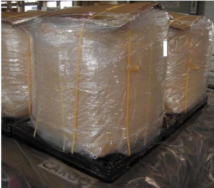
袋は一段積みとして底板に納まる大きさとし、バンドルでスキッドなどの底板と天板で製品が十分な強度にて固縛されていることを条件に、スキッド(シュリンクまたはストレッチ包装)での輸送が可能です。
